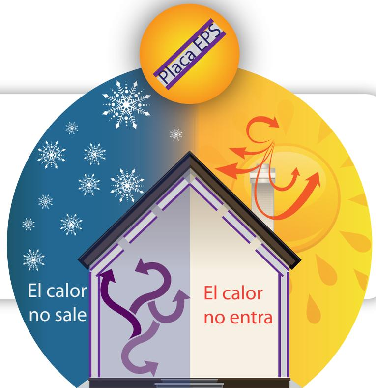
Figura 2. Aislamiento térmico de viviendas con placas de EPS.
